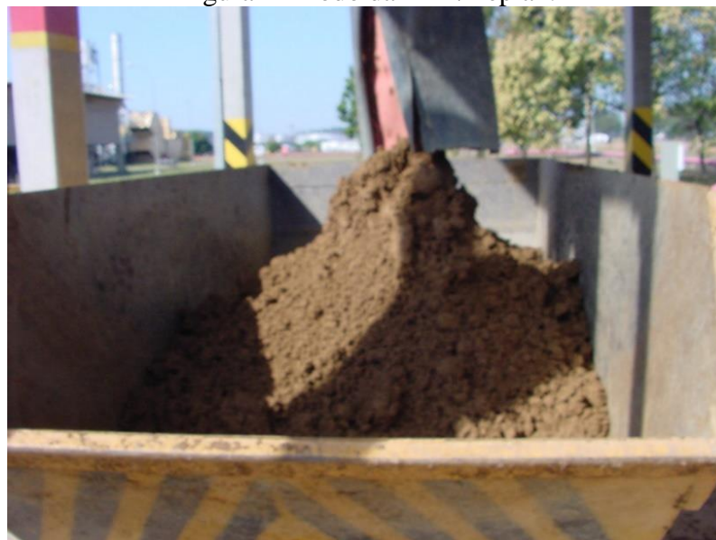
Figura 2 - Lodo da ETA/Replan.
