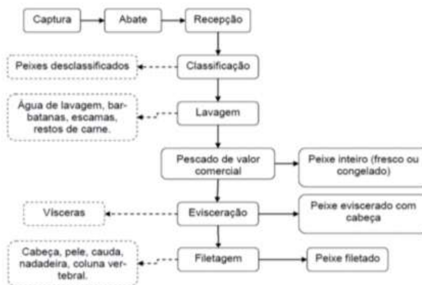
Figura 1 – Fluxograma geral do processo de beneficiamento de pescado.
